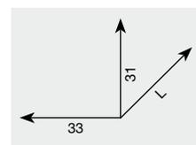
**220 LE** CATENACCIO VERTICALE TONDO BASE mm 33 CORSOIO Ø mm 13 CON CORSA LUNGA mm 85 e blocco di sicurezza
