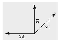
**220 L** CATENACCIO VERTICALE TONDO BASE mm 33 CORSOIO Ø mm 13 CON CORSA LUNGA mm 85
